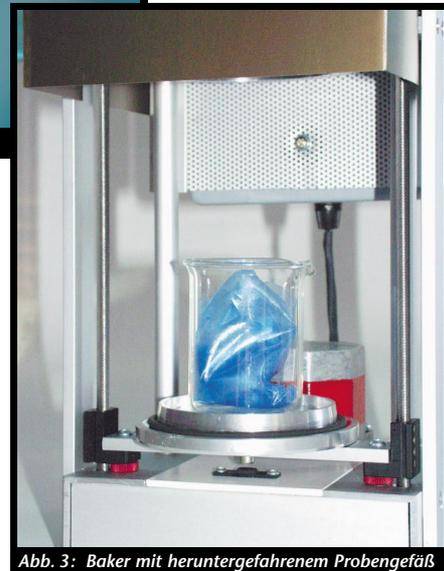
Abb. 3: Baker mit heruntergefahrenem Probengefäß
