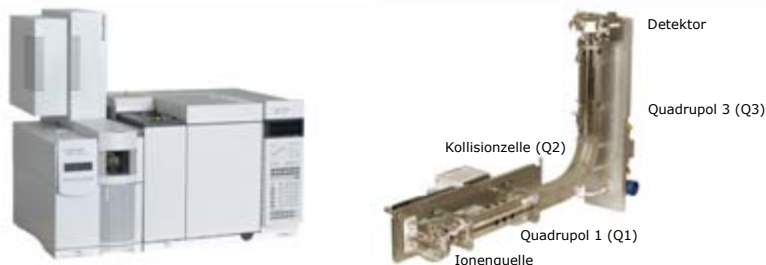
CHROMTECH EVOLUTION GC-MS/MS: Links: Außenansicht. Rechts: Ionenpfad bestehend aus Original-Ionenquelle, hyperbolischem goldbedampften Quarz-Quadrupol (Q1), IonRail Kollisionszelle (Q2) und Hochpräzisions-Quadrupol (Q3).
