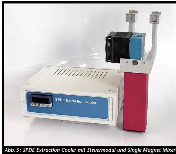
Abb. 5: SPDE Extraction Cooler mit Steuermodul und Single Magnet Mixer
