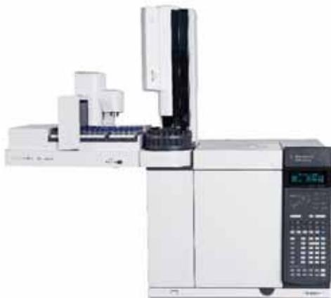
Der automatische Flüssigprobengeber (ALS) der Serie 7693 von Agilent ermöglicht mit seiner Kapazität für 16 Probenflaschen und dualer Simultaninjektion die schnellsten Injektionszeiten von automatischen GC-Probengebern überhaupt. Für große Labore bietet die Plattform 7693A wahlweise eine Kapazität von 16 oder 150 Probenflaschen. Erweiterte Funktionen, z. B. automatisierte Verdünnung, interne Standard-Addition, Heizen, Mischen und Lösungsmittelzugabe, reduzieren Schwankungen und Nachanalysen.
