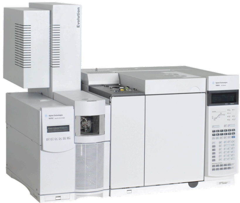
Fig.10: Das CHROMTECH EVOLUTION Triple Quadrupol GC-MS/MS bietet einzigartige Selektivität und Empfindlichkeit für die Analytik in schwierigster Matrix.
