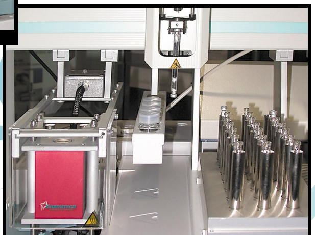
Abb. 2: Transport des Probenröhrchens durch den Injektionsarm des CTC PAL
