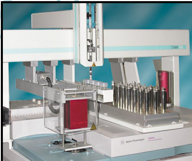
Abb. 1: Thermodesorber-Option am CTC PAL mit Agilent GC 6890
